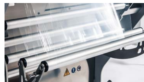
Optimiertes Abwickel- und Spannsystem der Folie
