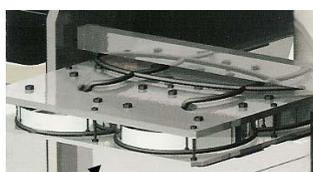
Rapida sostituzione dello stampo e controstampo
